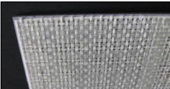
Плиты с армированной тыльной стороной толщиной 3,5 мм
